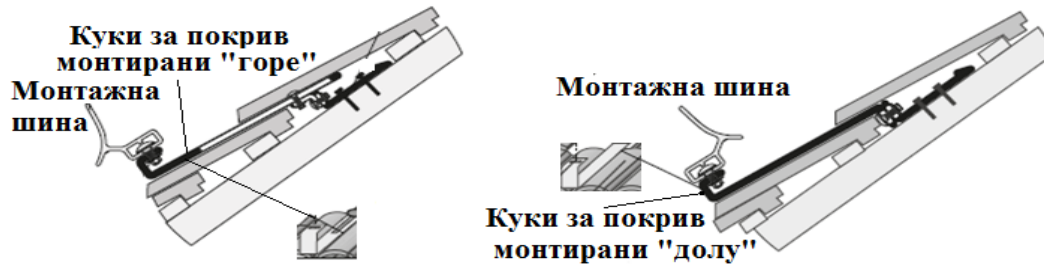
Фиг.3.2. Монтаж на куките за покрив върху покривни греди
