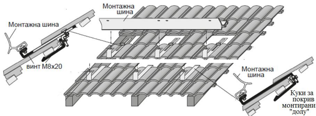
Фиг.3.1. Монтаж на куките за покрив върху покривни летви
