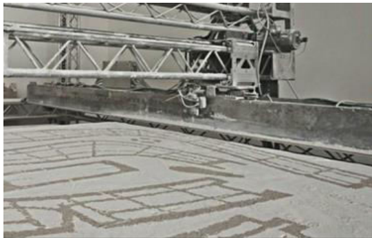
Фигура 6. Технология на принтиране с D-образна форма (принтиран слой)
