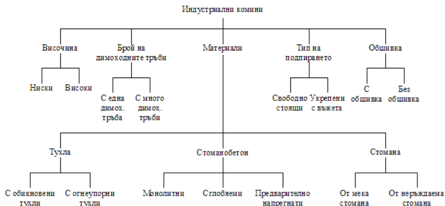
Фиг.1.1. Класификация на индустриалните комини [86]
